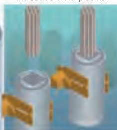
El contenedor ENSA-DPT se introduce en la piscina.
