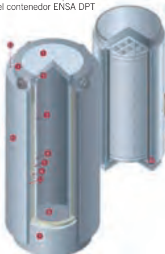
Modelo descriptivo del contenedor ENSA DPT
